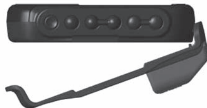
Установка прибора Foretrex 201 в зарядное устройство
